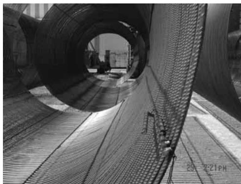
Figura 12 – Fabrico de tubos armados: etapa da produção das armaduras
