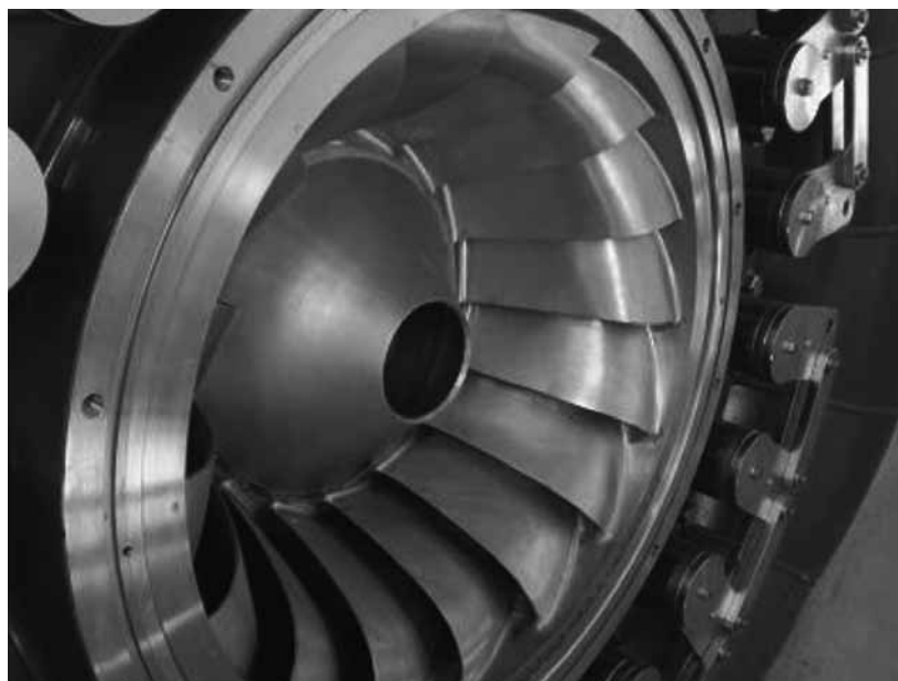
Figura 4 - Roda da turbina (690mm de diâmetro)
