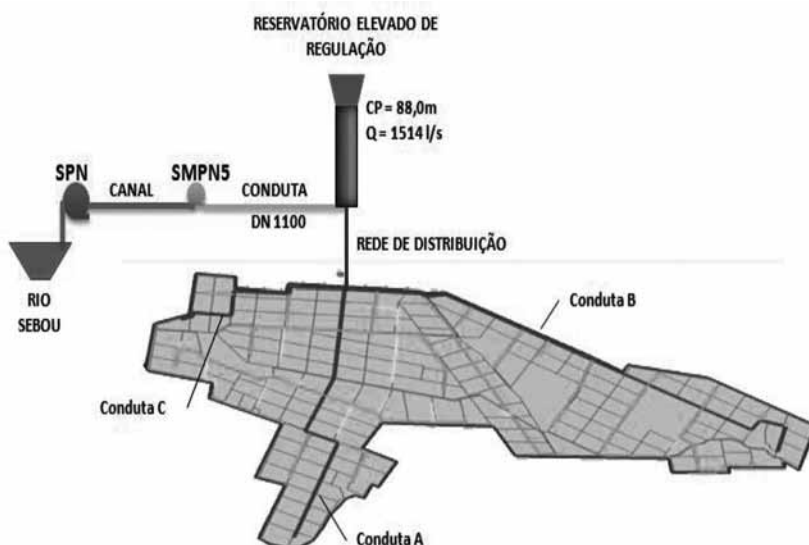
Figura 3 – Esquema hidráulico actual do sector N5.
