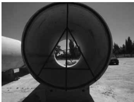
Figura 14 – Controlo dimensional das boquilhas
