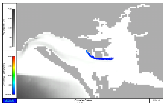
Figura 3: Pluma da descarga da Navigator. A escala representa a razão entre a concentração em cada ponto e a concentração no efluente. O valor mínimo representado é 0.01 e, por conseguinte, fora desta zona a pluma está diluída mais de 100 vezes. A cor azul representa diluição superior a 20 vezes.
