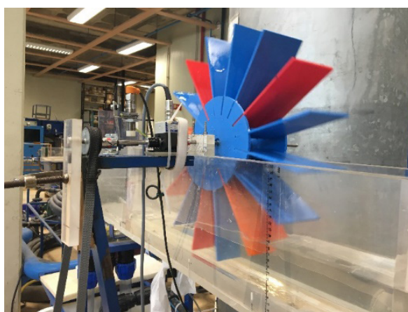
Figura 1. Instalação experimental: roda hidráulica com 16 pás.
