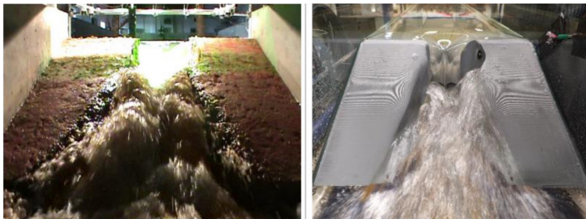
Figura 2 - Vista frontal. Ensaio de base na Instalação experimental nº 1 no LNEC (50cm de altura) vs ensaio preliminar na Instalação experimental nº 3 no IST (13,2cm de altura).
