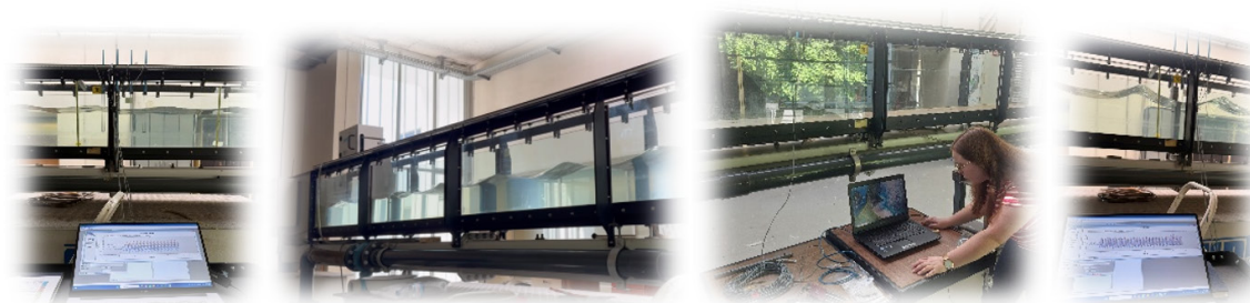
Figura 1 – Preparação da instalação experimental no canal hidráulico da Universidade do Minho com sondas de medição HrWallingford e sondas laser especificamente concebidas para o trabalho em curso.
