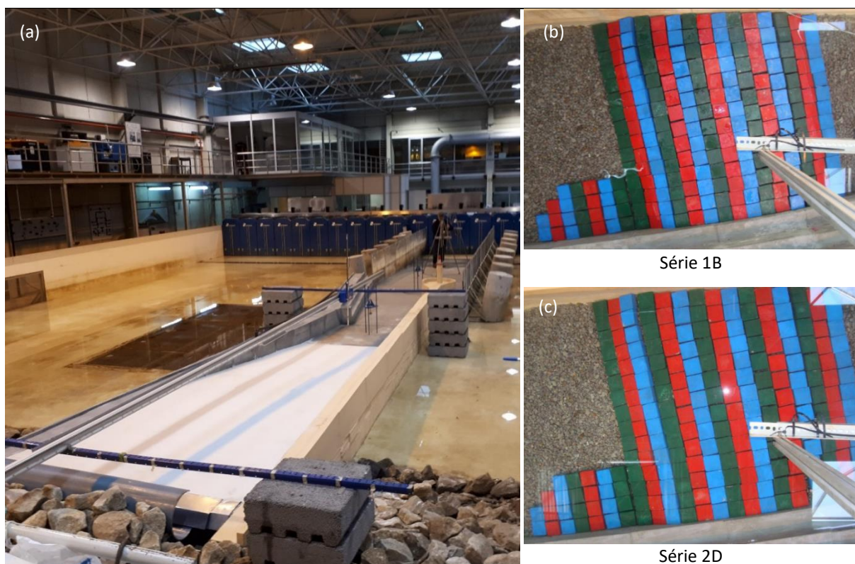
Fig. 3. Modelo físico da Praia das Pastoras (a). Manto resistente do novo quebramar com a disposição dos blocos no final da série de ensaios: (b) 1B (nível +0.50 m ZH) e (c) série de ensaios 2D (nível +4.50 m ZH).
