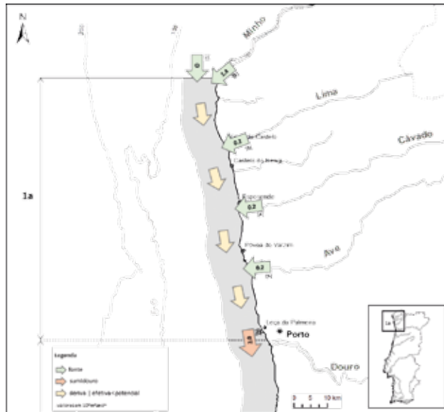
Figura 2.4 - Célula 1, subcélula 1a: balanço sedimentar na situação de referência.
