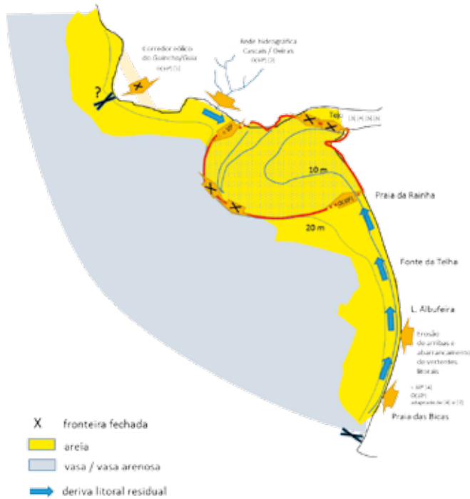
Figura 42 - Balanço sedimentar esquemático do estuário exterior do Tejo e regiões adjacentes (cobertura sedimentar da plataforma adaptada de Balsinha, 2012).
