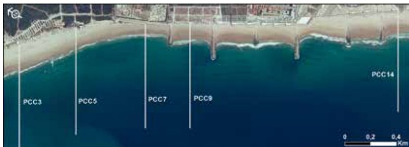
Figura 6 - Seleção de perfis efetuados nos levantamentos topo-hidrográficos.
