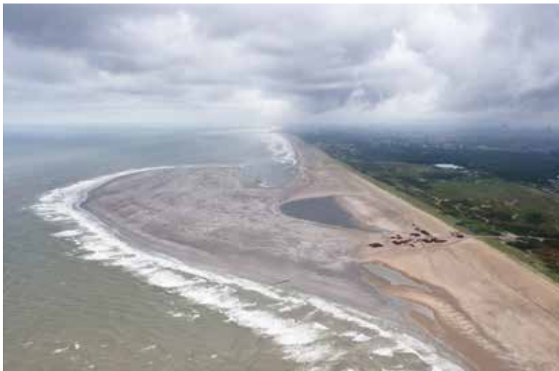
Figura 8.26 - Deposição de um elevado volume de areia numa única operação (The Hague, Holanda)
