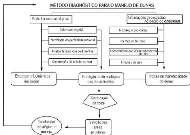
Figura 2. Fluxograma para o diagnóstico, classificação e seleção de áreas prioritárias ao manejo de dunas no litoral de Imbé-RS, usando critérios de vulnerabilidade, morfodinâmica de praia e morfoecologia de dunas.
