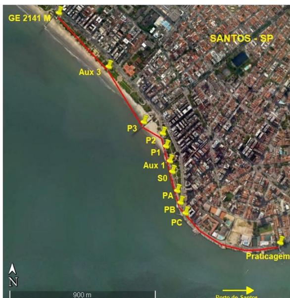
Figura 4: Localização dos pontos e poligonal do nívelamento geométrico.
