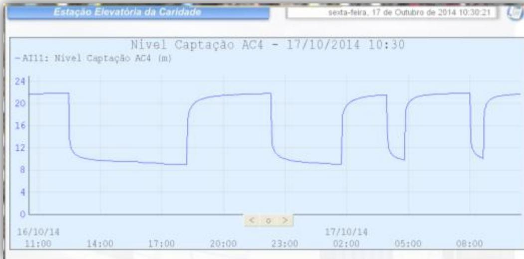
Nível estático / dinâmico da água na captação
